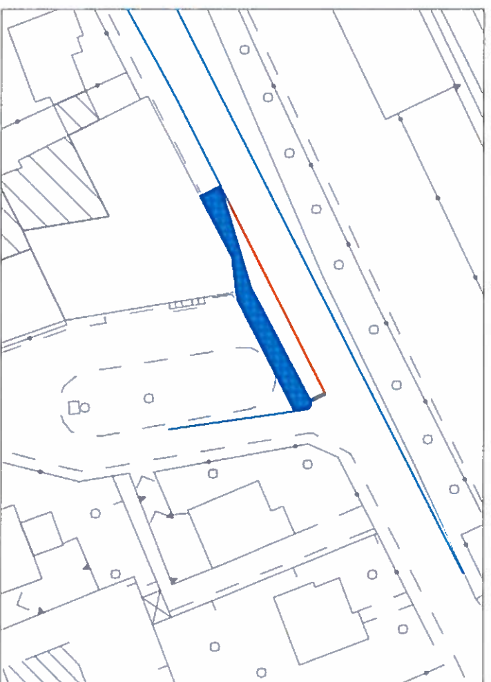
Fig.2.2 Schema della chiusura di un ramo della via Cattaneo per creare una zona di attesa bus
